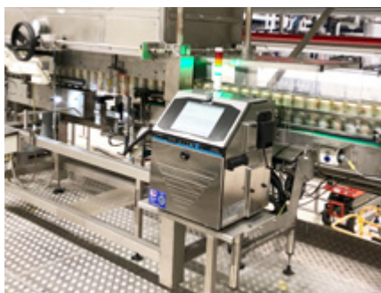
Der Twin Nozzle-Drucker verfügt über zwei Düsen je Druckkopf und kodiert bis zu 45.000 Dosen in der Stunde.
